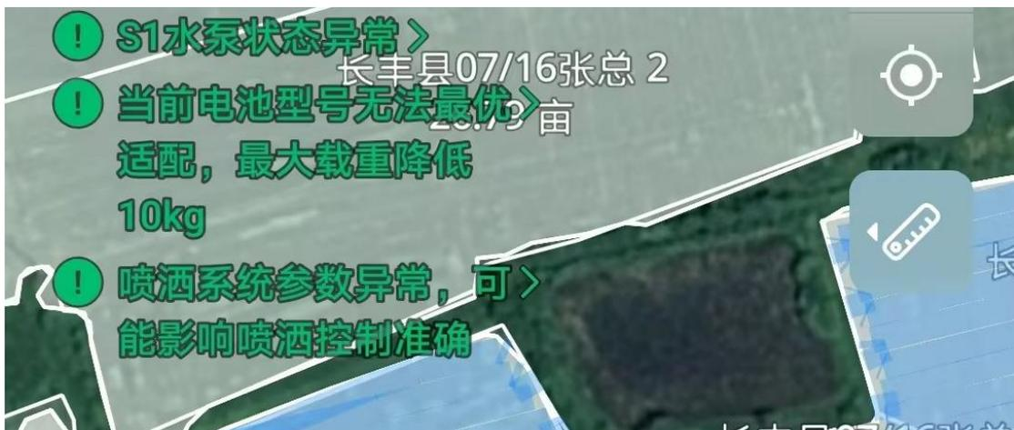
处理方法：拆开叶轮看一下，有没有泡大，还在叶轮有没有高于泵腔边，如果有，就需要更换叶轮，高于泵腔，会报转速异常，就是堵转。
