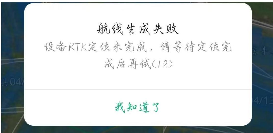
处理方法：设备未进入 RTK 定位状态，等待设备进入 RTK
